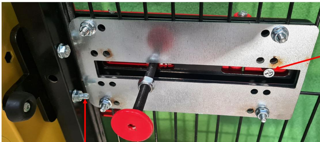
Vite anti svitamento ma non impedisce la regolazione della serratura
