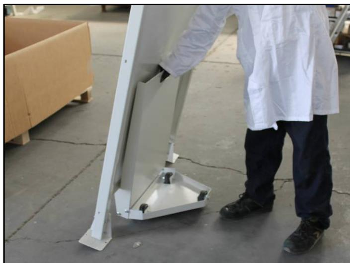
Estrarre il carrello dalla cassa, piegarlo sino a fare combinare i fori con le viti libere. Serrare le viti e fare scivolare il pannello a terra. Portarlo in posizione verticale senza sollevarlo. Poi agganciare il carrello e trasportarlo.
